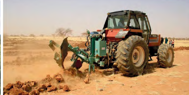
Delfino plow digging micro basins (Lindo Grandi).
